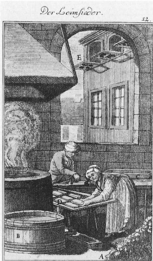
A. Leimleder. B. Klarbütte. C. Kästen, in welchen der Leim gerührt, und in Tafeln zer schnitten wird. D. trocknerahm. E. Leimboden, wo der Leim ge trocknet wird.
