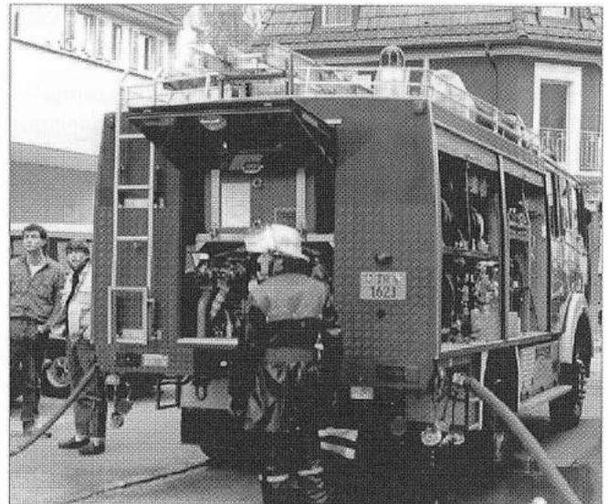
Das Tanklöschfahrzeug mit 7 Mann Besatzung und einem Gesamtgewicht von 13 000 kg ist ein schnelles, von einem Wasserbezugsort unabhängiges Löschfahrzeug. Es ist mit einem 204-PS-Dieselmotor, mit einer Pumpe, einem Tank mit 3 000 Litern Wasser und 60 m Schlauch für einen Schnellangriff ausgerüstet.
